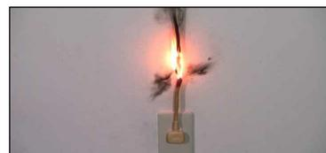
【NITEの再現実験】エアコンの電源コードをねじり接続して発火する様子
