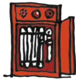
屋内消火栓設備
