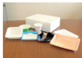
発泡スチロール容器 カップ麺、肉・魚・野菜・惣菜トレイ、ト口箱など
